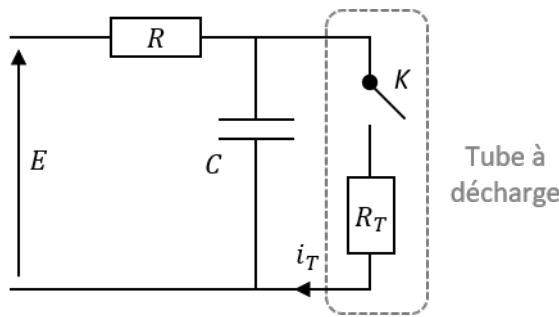
Une tension  $E$  constante de quelques centaines de volts est utilisée pour charger un condensateur de capacité  $C$ .
